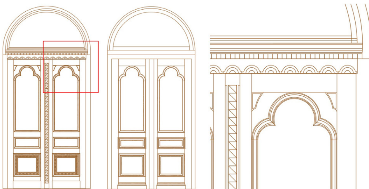
Slika 35. Dvokrilna ulazna vrata s drvenim ukladama i staklom s lučnim nadsvjetlom (nacrt lijevo i detalj gore)
