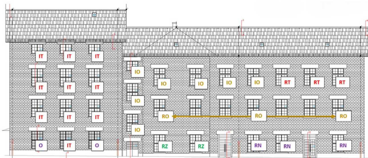
Slika 5. Pogled na zapadno pročelje zgrade Gliptoteke Hrvatske akademije znanosti i umjetnosti pokazuje da su zatečeni prozori većinom izvorni oštećeni IO ili izvorni zahvaćeni truleži IT . Značajan broj prozora su i replike koje možemo svrstati kao zdrave RZ , oštećene RO , trule RT ili neodgovarajuće RN . Na dvije pozicije nema prozora O .
