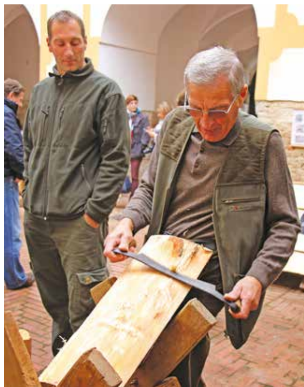
1 Prezentacija skidanja „makljom“ ili „rezivnikom“ suvišne biljne mase. Anton Štimac i sin Borivoj, nastavljajući tradicije izrade i pokrivanja krovništva šindrom u Gorskom kotaru. (foto: G. Jerabek)
