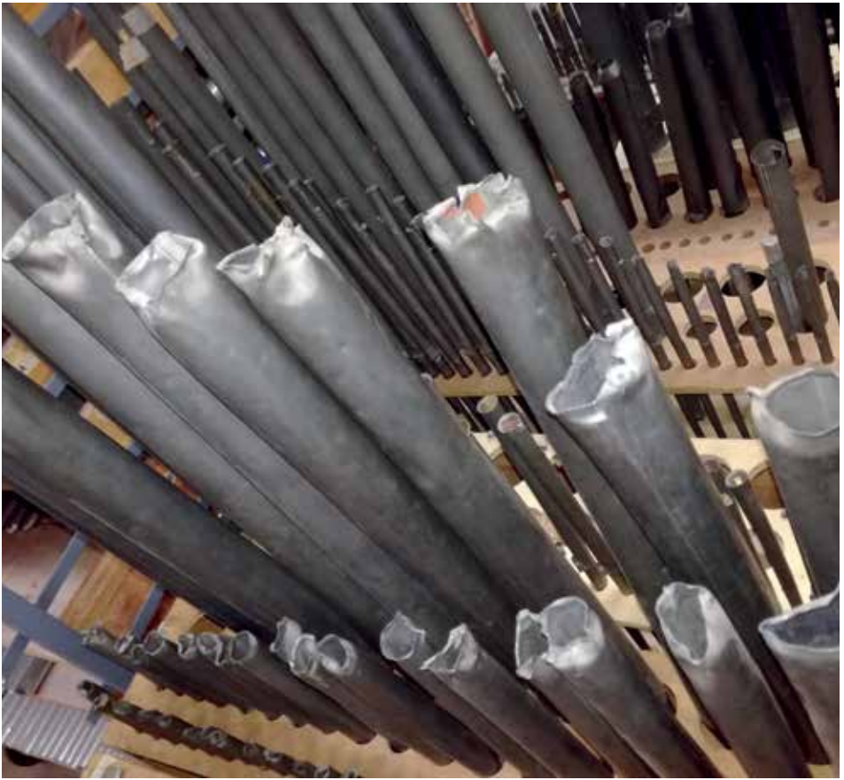
Nestručno „obnavljane“ i uništene metalne svirale
