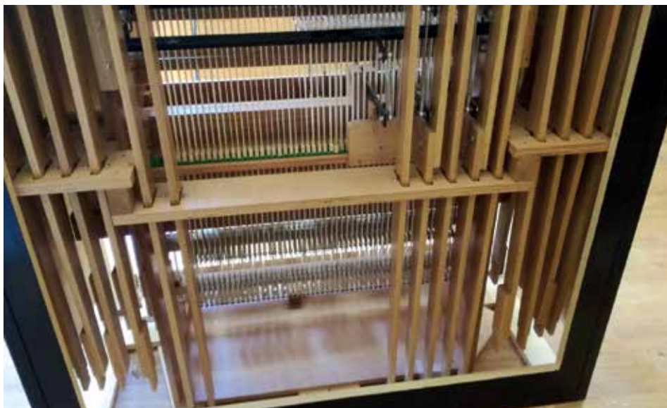
Obnovljeni apstrakti, svirna i registarska traktura
