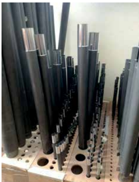
Obnovljene metalne svirale
