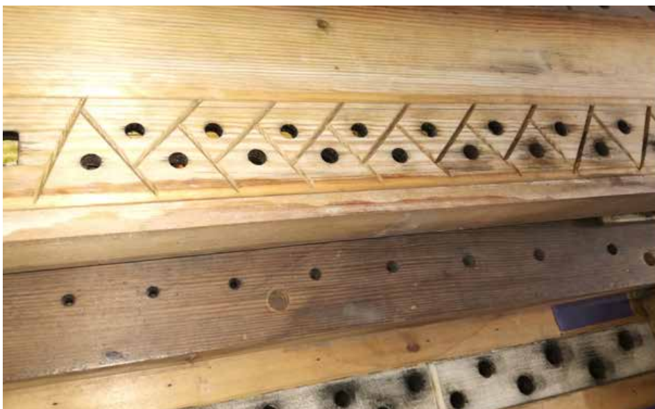
Prikaz „španjolskih kancela“ i mjesta za svirale na štoku, gdje je vidljivo propuštanje zraka u vidu crnih mrlja
