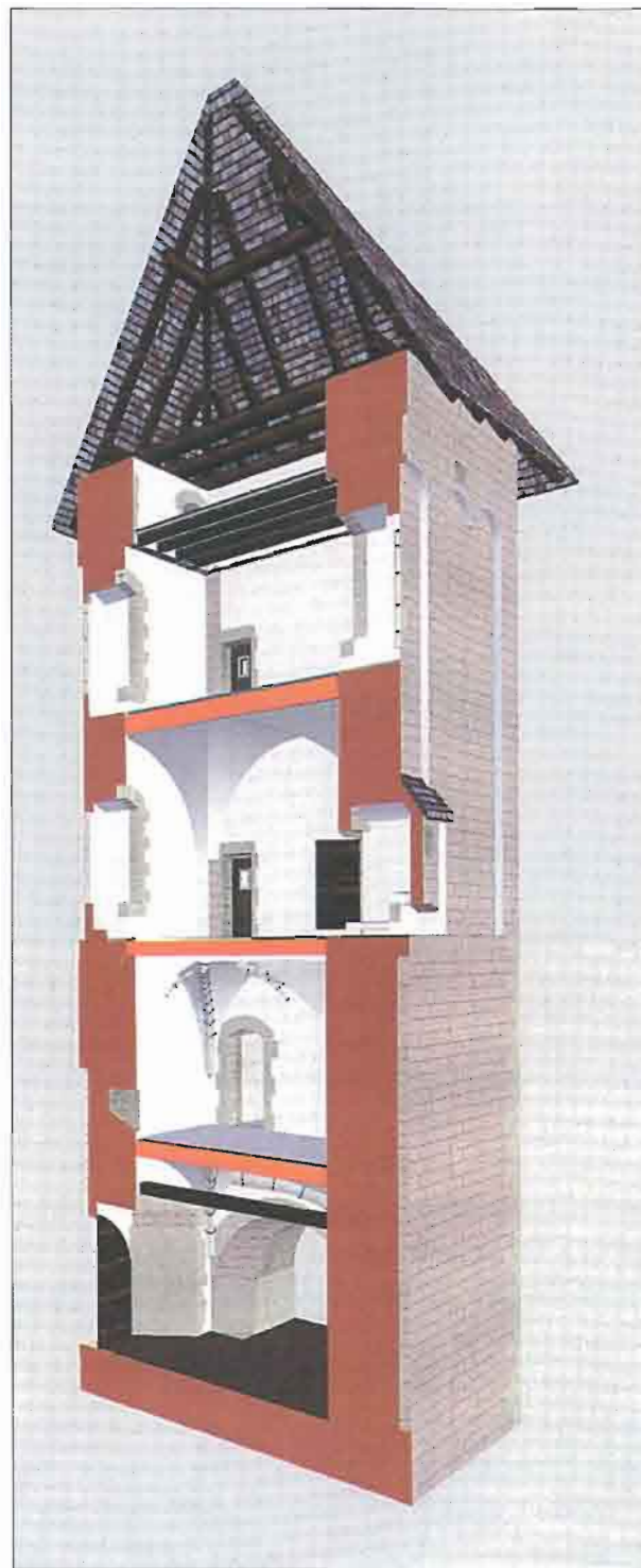
115 Frankopanska kula, presjek sjever-jug, pogled prema sjeveroistoku, kompjutorska vizualizacija (Studio »Kušan«) Frankopan Tower, north-south section, view to the north east, computer visualisation (the Kušan Studio)
