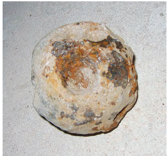
13 Željezna kugla koja je bila uglavljena u kobilicu i na koju se oslanjao osnac (foto: Sanja Buble, 2008.) Iron ball embedded in bar keel and on which the shaft leaned (photo by Sanja Buble, 2008)
