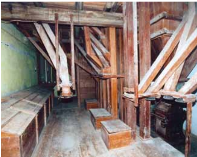
10 Dijelovi unutrašnjeg postrojenja: cijevi za razvrstavanje brašna i kištre za skupljanje razvrstanoga brašna, stanje 2006. (foto: Z. Bogdanović)
